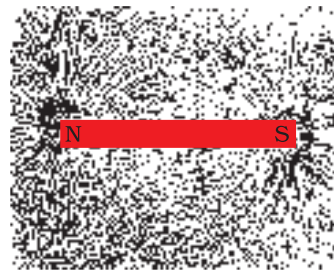
चित्र 13.2 छड़ चुंबक के निकट का लौह-चूर्ण स्वयं ही चुंबकीय क्षेत्र रेखाओं के अनुदिश सरेखित हो जाता है
