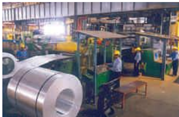
चित्र 6.6 – नाल्को प्रगलक में पट्टी लेप मिल
